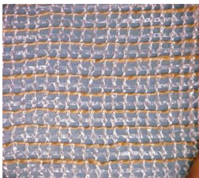
Fig. 18(b) : Jute-synthetic leno-weave fabric
